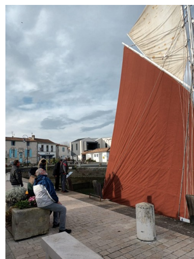
Essai avec l'ancien flèche pour vérification et rectification de coupe .
